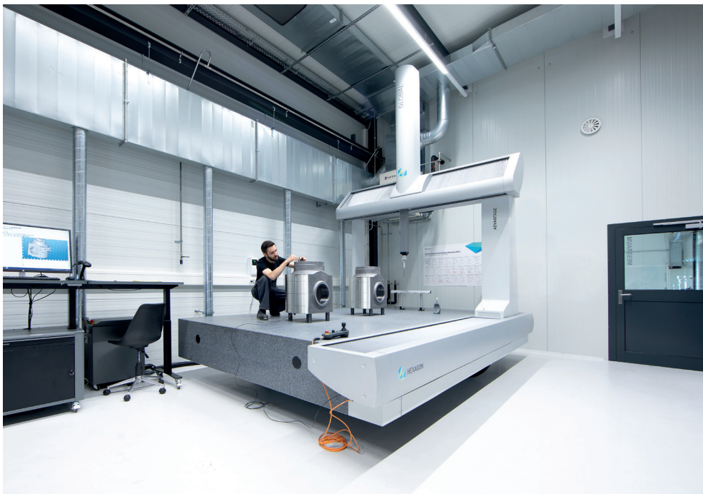
Klimatisierter Messraum bei 20\pm 0.5 °C, Güteklasse 3 nach VDI / VDE 2627
